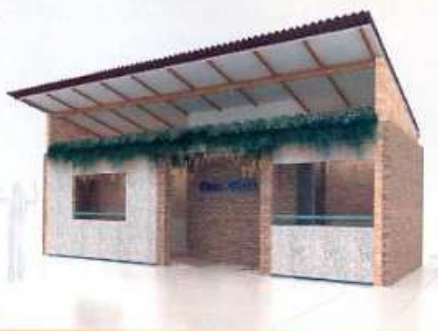
A Casa Aqua possui vegetação na laje para moderação climática e abertura lateral para ventilação forçada, minimizando o uso de ar condicionado
